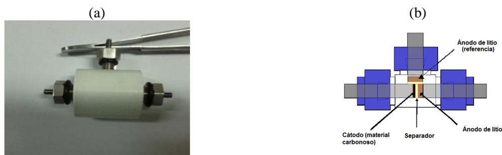
Figura II.3: (a) Fotografía del prototipo de celda electroquímica ensamblada y (b) disposición de los electrodos en la celda
