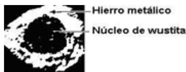
Fig 3.14 Sección transversal de un pelet reducido a 1 523 K
