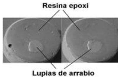
Figura 2.1. Probetas de lupias encapsuladas para estudio metalográfico
