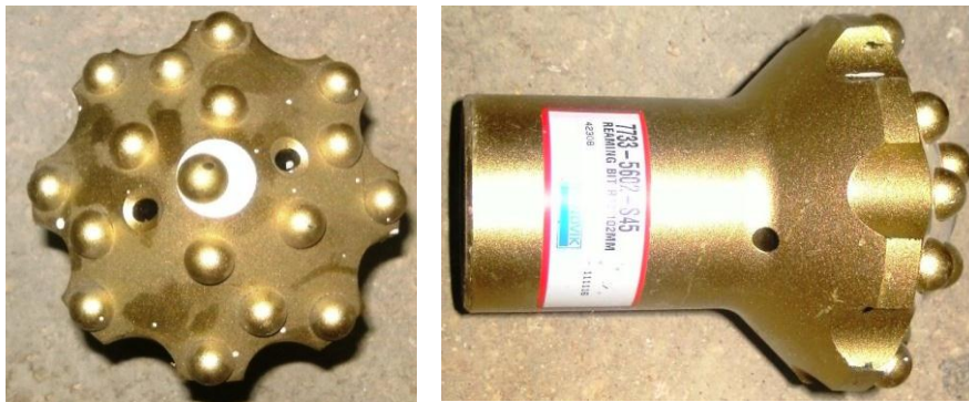
Figura 2. Broca de 102 mm de diámetro para el barreno vacío del corte.
