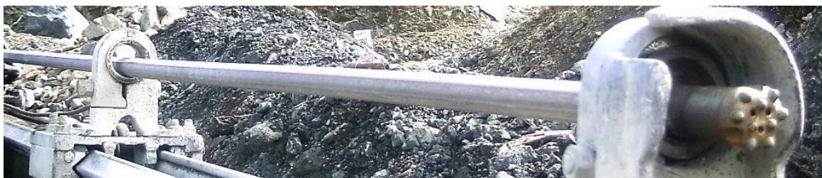
Figura 4. Barrena de 3,40 m de longitud.
