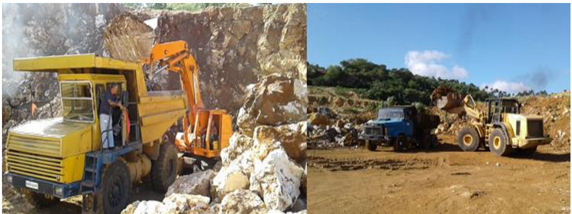
Figura 4.9. Combinación camión Belaz - excavadora Hitachi y camión Kraz - Cargador frontal
