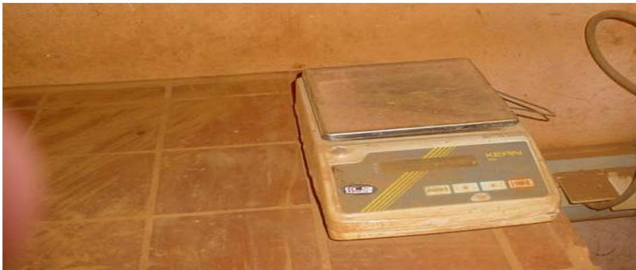
**Figura 1.** Balanza utilizada para determinar la masa de las muestras de menas lateríticas.
