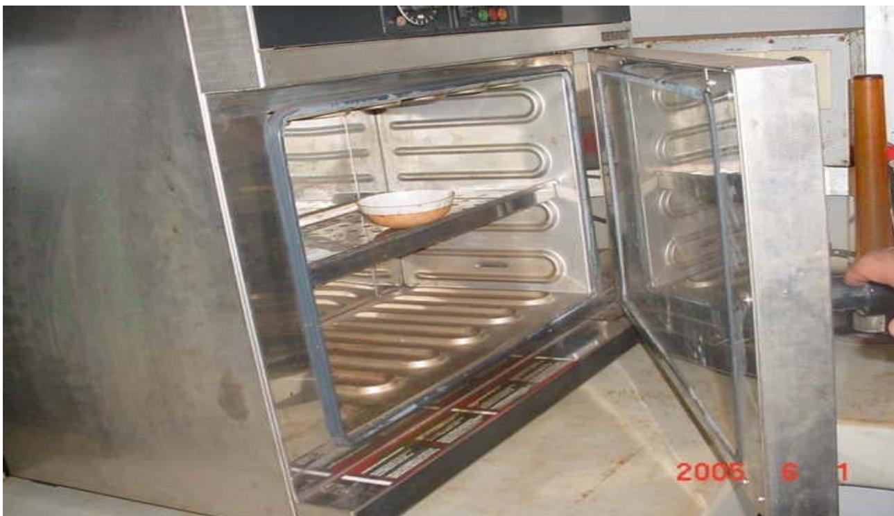
**Figura 2.** Estufa utilizada para la extracción de la humedad de las menas lateríticas.
