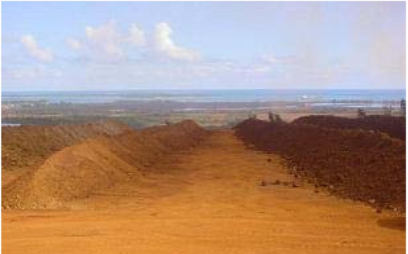
**Figura 1.1.** Implementación del proceso de secado natural de las menas lateríticas en Moa.
