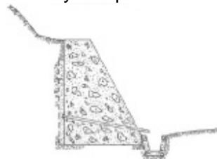
Figura 3.9.- Muros de Gravedad de Concreto
