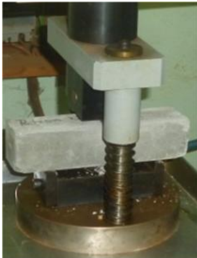
Figura 2.6 Aditamento para la flexotracción
