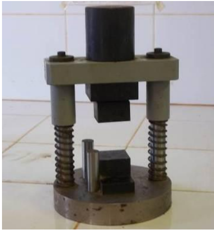
Figura 2.7 Aditamento para la compresión.
