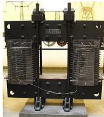
Figura 1.1 Primer prototipo de bobina resonante construida en 1917.
