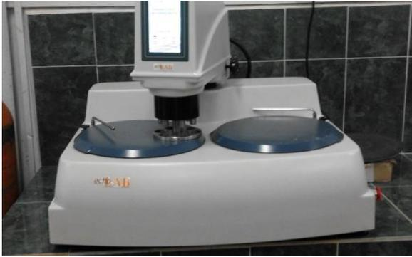
Figura 2.4. Pulidora metalográfica marca PM 52 D.
