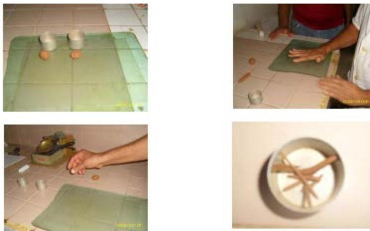
Figura.32 Ensayo de límite plástico
