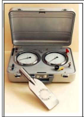
Figura 26 Dilatómetro Plano
