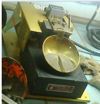
Figura 30. Determinación del límite líquido
