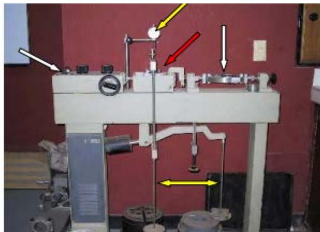
Figura 35. Ensayo de cortante directo
