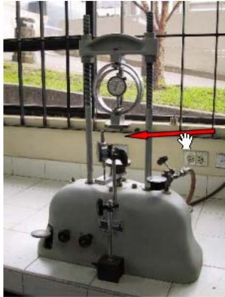
Figura 34 Prensa hidráulica
