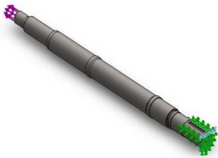
Figura 2.6 condiciones de frontera
