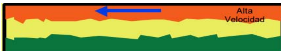
Figura 1.9. Lubricación hidrodinámica (Fuente: Shell, 2011).
