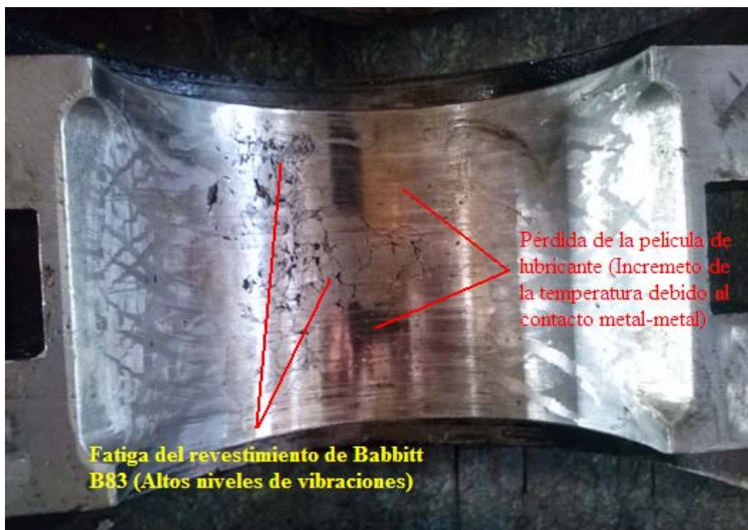
Figura 3. Fatiga y cambio de color del revestimiento de metal Babbitt B83.
