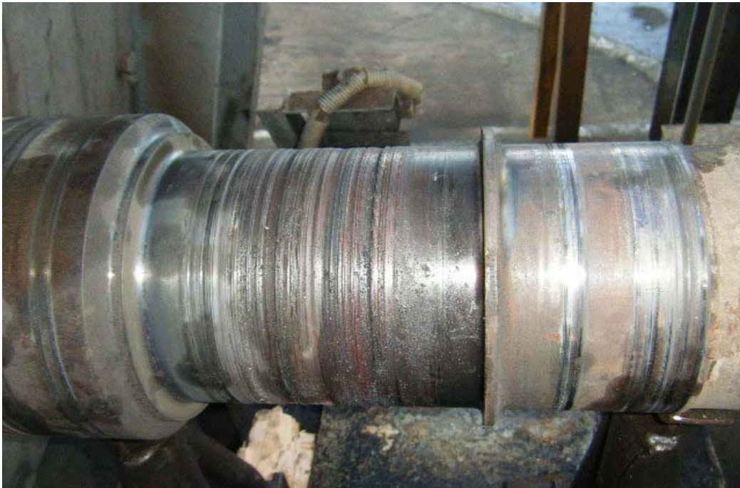
Figura 4. Rayaduras del muñón del VTF.
