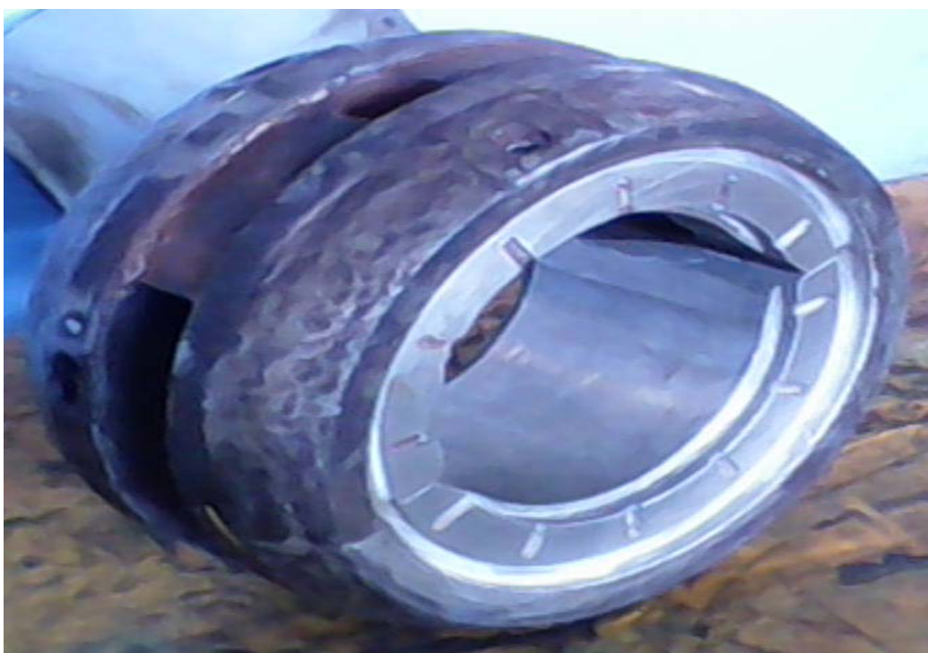
Figura 2. Chumacera lado coupling de los VTF.
