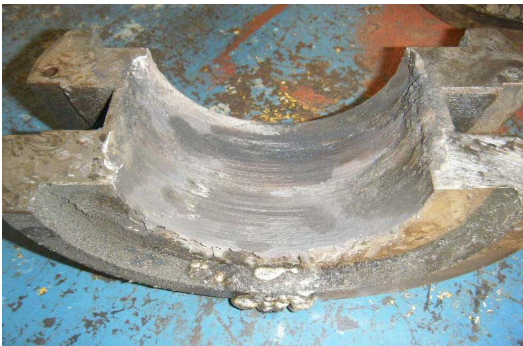
Figura 5. Fundición del material antifricción Babbitt B83.
