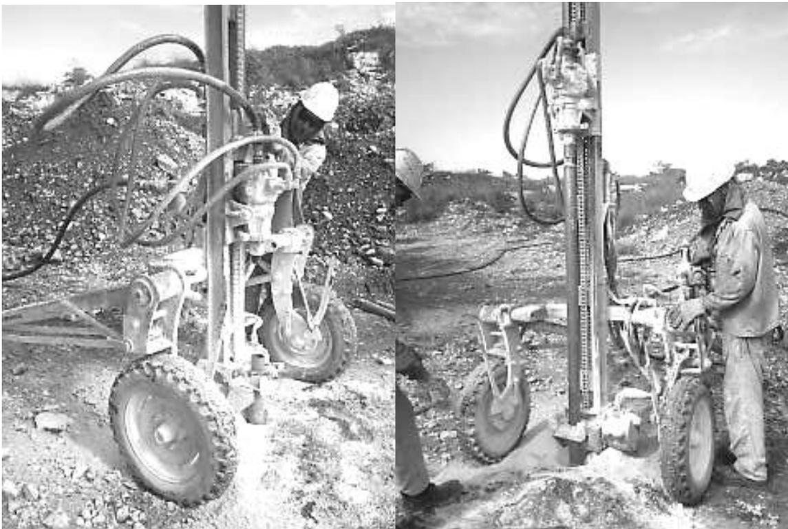
Figura 2.4 Carretilla barrenadora Atlas Copco
