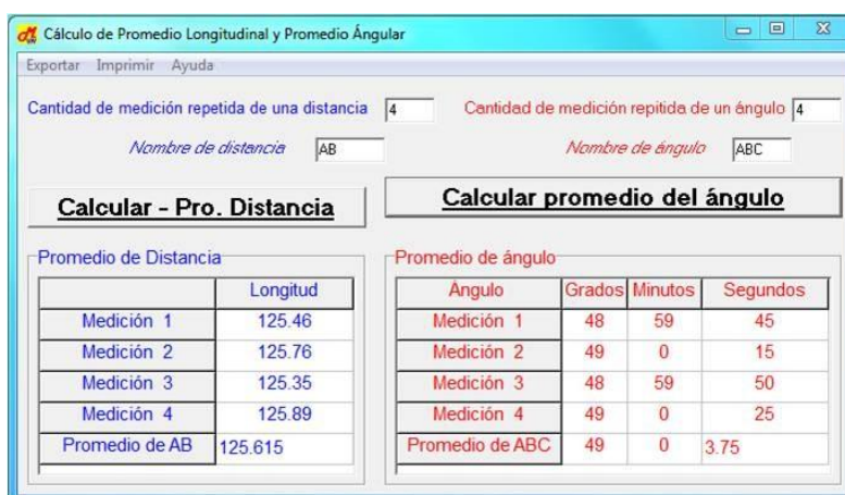
Figura 8: Programa del cálculo del promedio de una distancia y de un ángulo.
