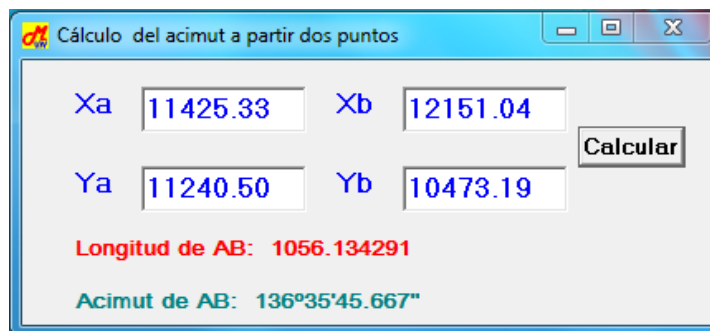
Figura 12: Programa para el cálculo de acimut a partir dos puntos conocidos.
