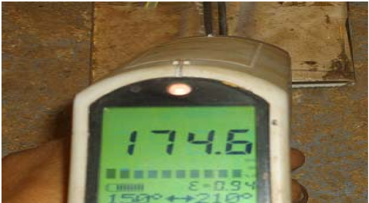
Figura 1. Medición de la temperatura de calentamiento con el empleo del pirómetro.
