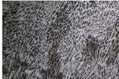
Figura 3.2. Cordón de soldadura muestra 1
