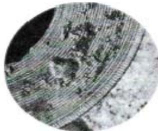
Figura # 1. Corrosión por Fisuras.
