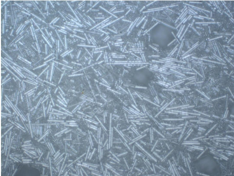
Figura 4.4.1.: Fibras de tipo E silanizadas a pH 3,68 observadas al microscopio (x100)
