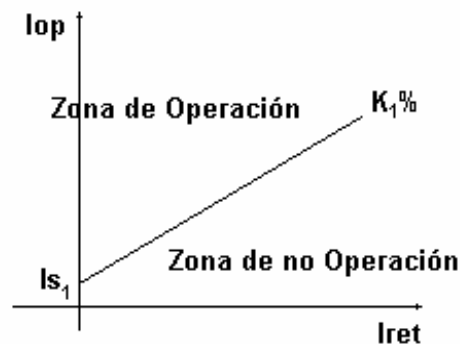
Figura 1.13 Característica hipotética de un relé de porcentaje diferencial.
