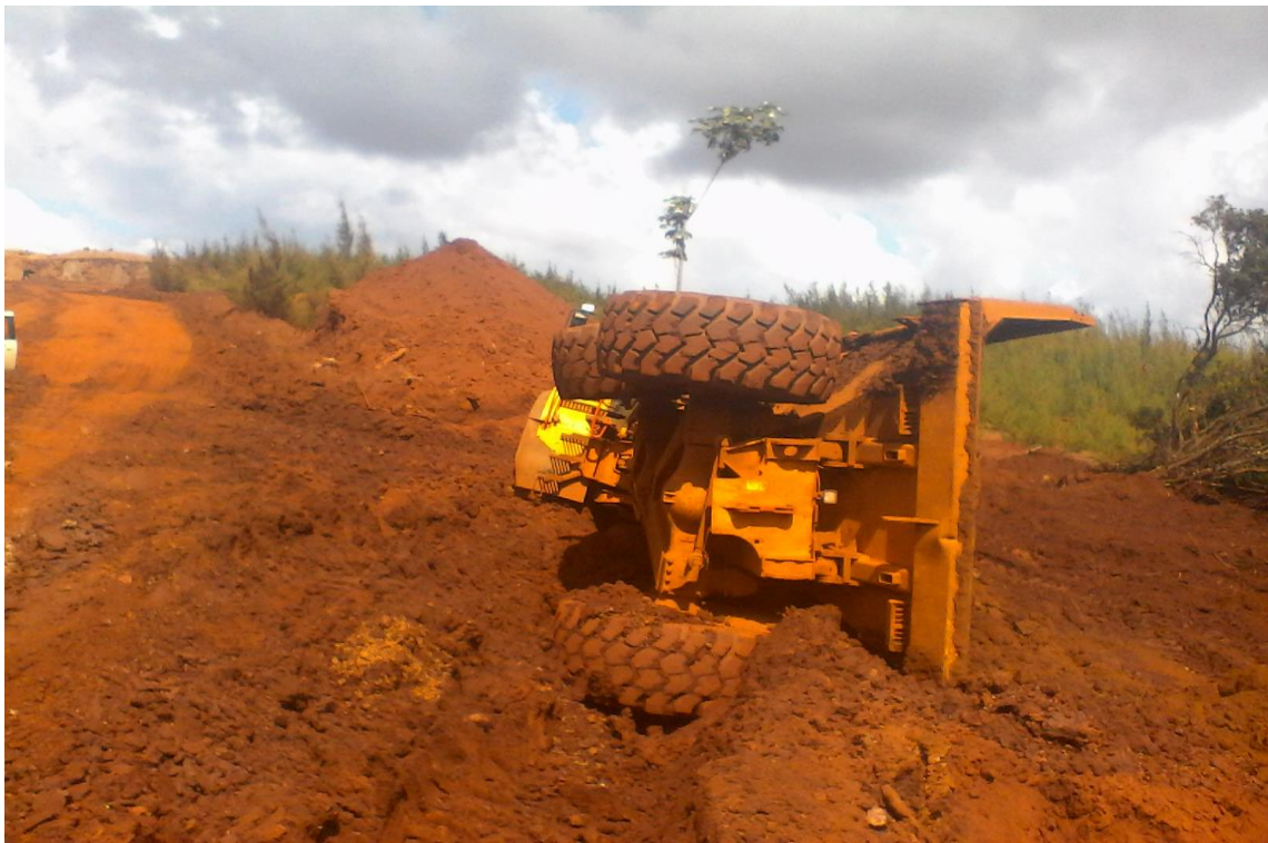
Figura 1. Vuelco de camión articulado en camino secundario.
