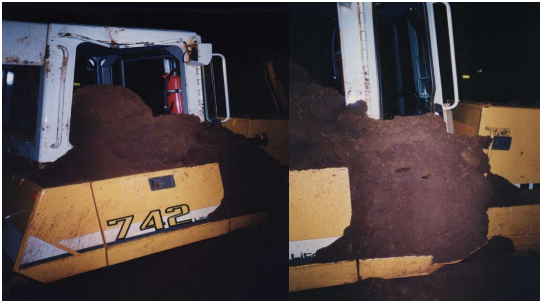
Figura 6. Atascamiento de Buldóceres sobre esteras en la escombrera.
