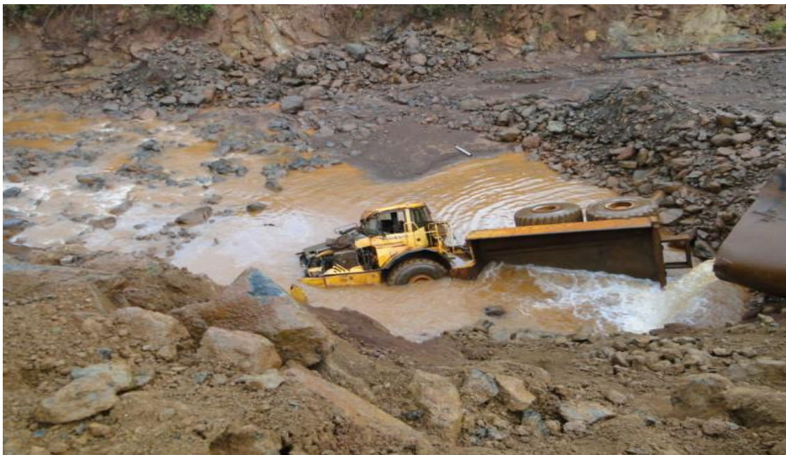
Figura 4. Vuelco de camion articulado en puente de camino principal.
