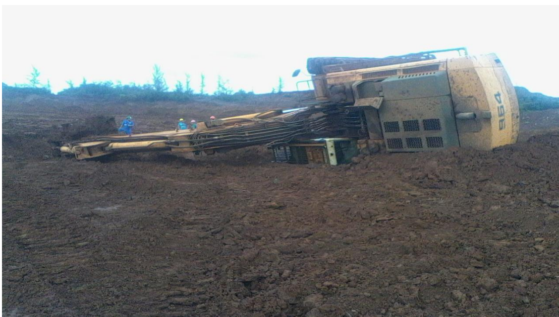
Figura 5. Vuelco de Retroexcavadora hidráulica sobre esteras en depósitos mineros.
