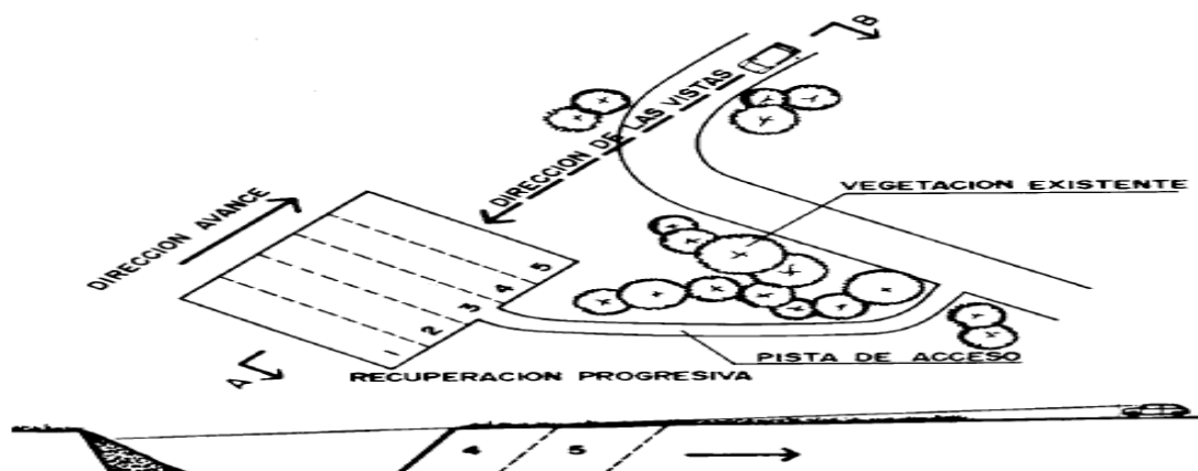
Figura 3. 19: Orientación del frente de trabajo perpendicular al eje de visión de un observador situado en una posición dominante.
