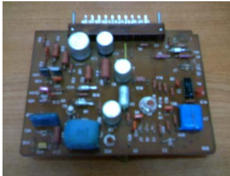
Figura 12. Circuito de mando del rectificador controlado.
