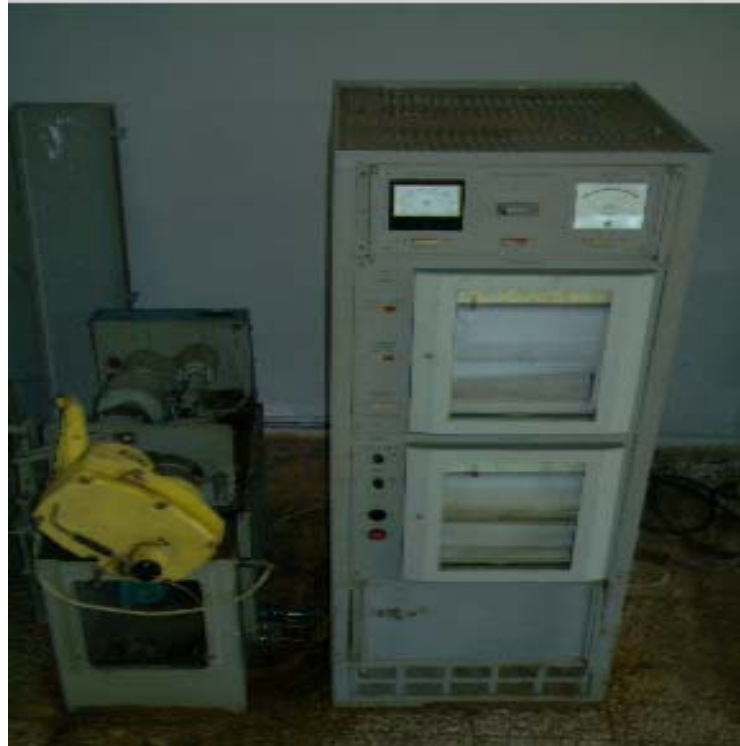
Figura 1. Máquina para el ensayo de materiales en fricción y desgaste 2070 CMT-1.
