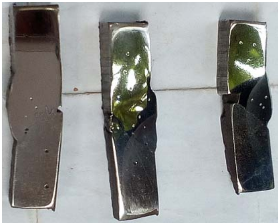
Figura 2.3. Preparación metalográfica de las muestras soldadas.
