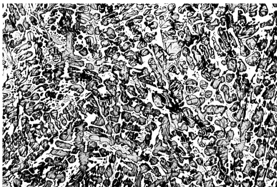
Figura 1.4. Estructura del hierro fundido blanco. Fuente: norma ASTM A 532
