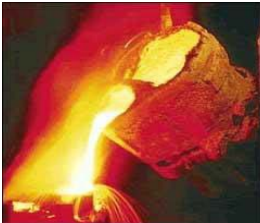
Figura 1.3. Vaciado del metal en el molde. Fuente: Olsen et al. (2010).
