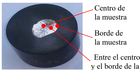
Figura 2.5. Zonas para la medición de dureza y microestructural.
