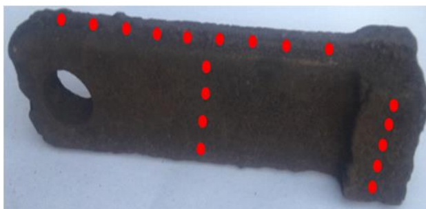
Figura 2.7. Barrido de dureza longitudinal
