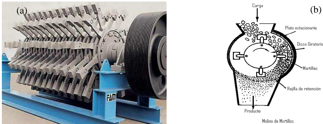
Figura 1.1. (a). Disposición de los martillos de un molino. (b). interior del molino.
