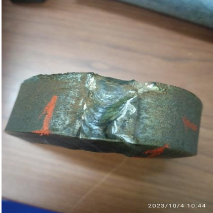
Figura 2.4 Material base soldada.
