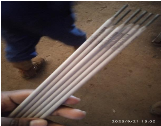
Figura 2.3 Material de aporte empleado durante el proceso metalúrgico.
