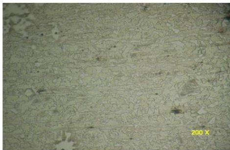
Figura 2.2 Microestructura del acero AISI 1025 según la norma ASTM E - 18.
