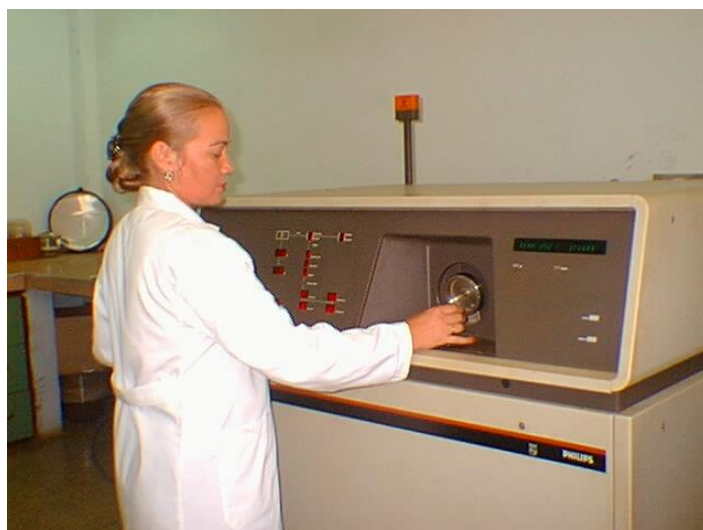
Figura 7. Espectrómetro de Fluorescencia de Rayos X. Laboratorio Central del CEINNIQ, Moa.
