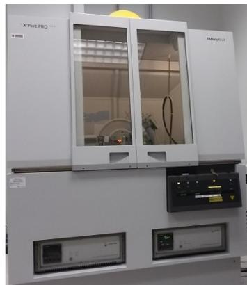
**Figura 2.8** – Difractómetro *PaNalytical X'Pert<sup>3</sup> Powder*
