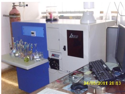
**Figura 2.6** - Espectrometría de Emisión Óptica de Plasma Inductivamente acoplado (ICP), Modelo JY 124
