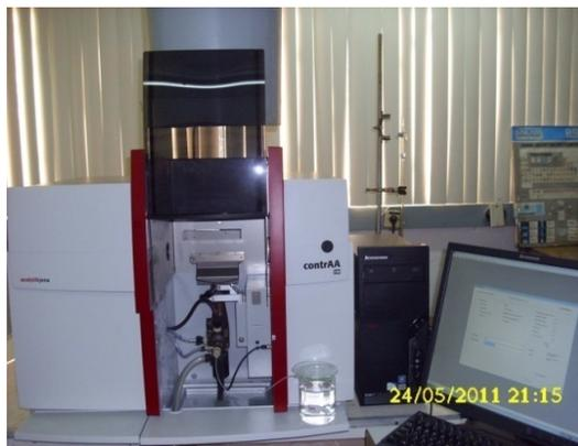
**Figura 2.7** - Espectrofotómetro de absorción atómica Modelo *ContrAA*® 300, de *Analytik Jena AG*
