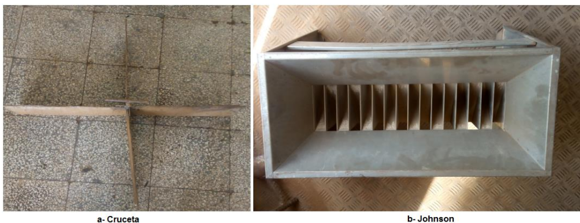
Figura 7. Cuarteadores utilizados para la preparación de las muestras.
