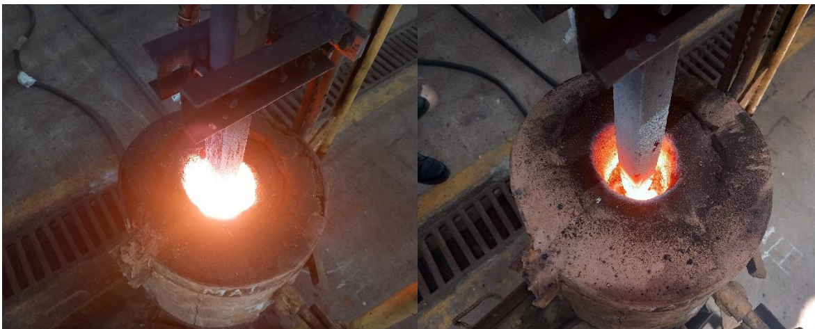
Figura 12. Horno de arco eléctrico empleado en las pruebas de fusión reductora.
