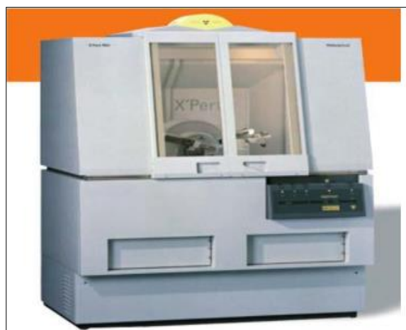
Figura 9. Equipo de difracción de Rayos X empleado en la caracterización mineralógica. Fuente: (CEDINIQ, 2024).
