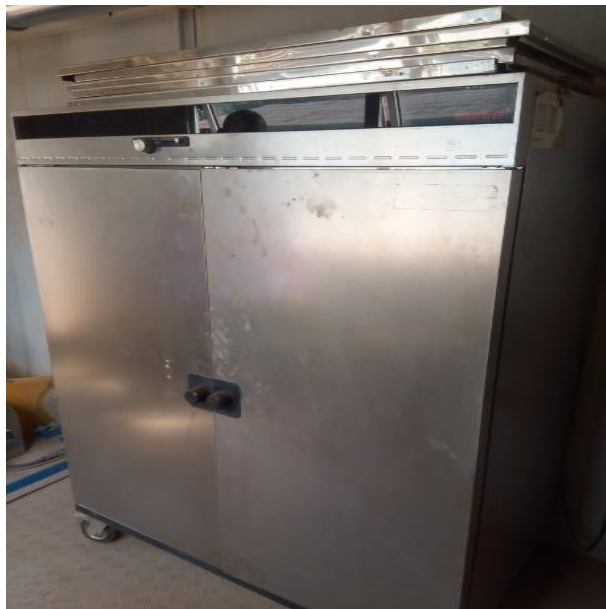
Figura 5. Estufa utilizada para el secado de las muestras experimentales.
