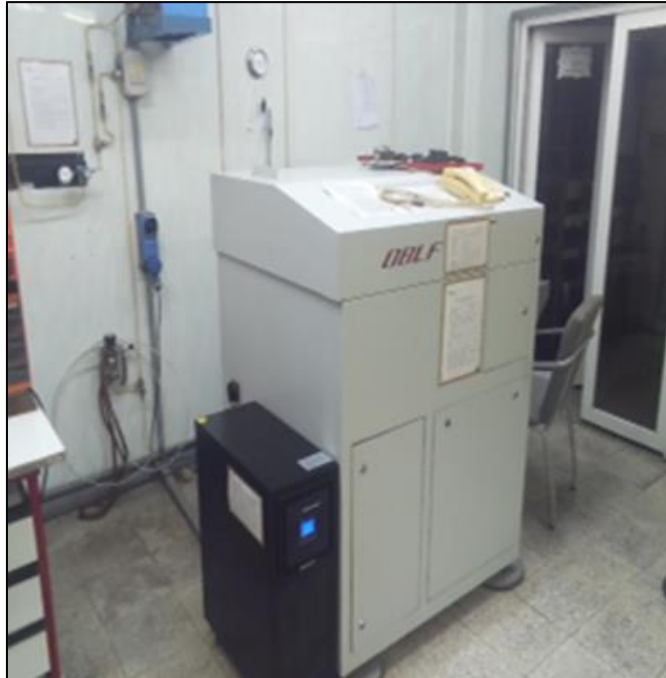
Figura 10. Espectrómetro de masa empleado en la caracterización química de los metales obtenidos.
