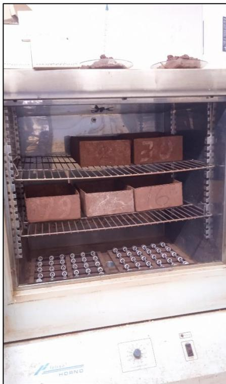
**Figura 3.** Estufa Eléctrica para el secado del mineral empleado en el análisis de la humedad.
