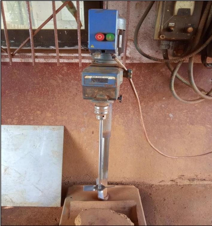
**Figura 6.** Agitador mecánico utilizado para preparar las pulpas de estudio. Tomado de (Pujol, 2023)
