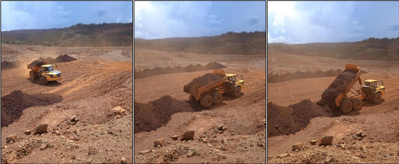
**Figura 1.** Conformación de las pilas en Depósito de Área 11 Moa Oriental.
