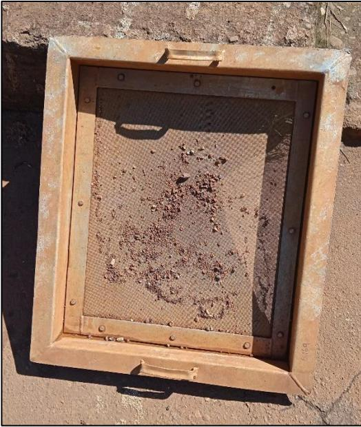
**Figura 4.** Tamiz malla de 20 mesh con el retenido de la pulpa.
